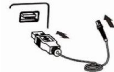
1. 将 USB 数据线的设备接口端（RJ48 接口）与 FM25-EX 相连；
