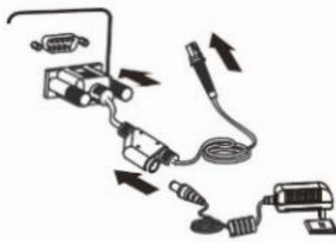
1. 将 RS-232 数据线的设备接口端（RJ 48 接口）与 FM25-EX 相连；
